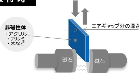
取付及び取外しの際は、本製品より面積が大きく、必要な工アギヤップ（磁石間隙）と同じ厚さの**非磁性体の板**（例：アクリル板等）を製品間に挟んでください。製品同士の吸着も防止できます。
