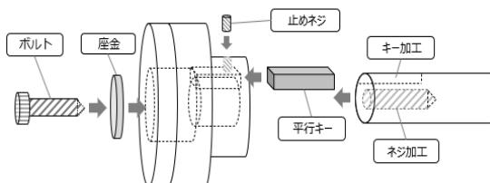
Φ45mm以上の円盤カップリングでは、カップリング同士の吸引力による抜け防止のため、規格に見合ったボルトにて取り付けシャフトへの頭止めを必ず行ってください。（製品にはボルトの頭が入るザグリ穴を設けてあります）
